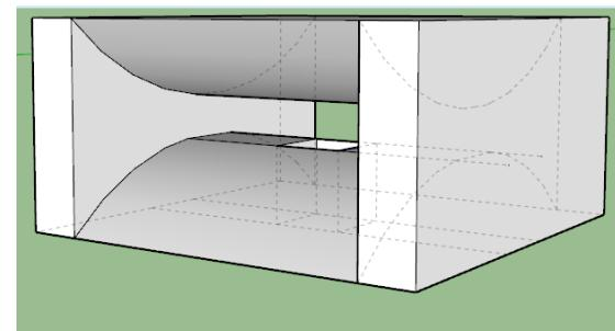
Donde,  $T_0$  representa el vano paralelo en menor proporción de tamaño que  $T_i$ , de esta manera se define el tamaño de aberturas de entrada y salida del componente.
