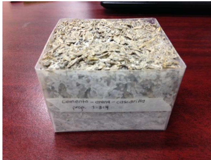
a) Probeta de cemento-arena-cascara de arroz
