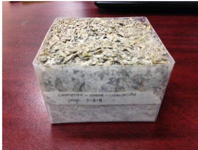
a) Probeta de cemento-arena-cascara de arroz
